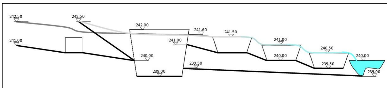
Figura 7 – Schema idraulico del sistema di finissaggio
