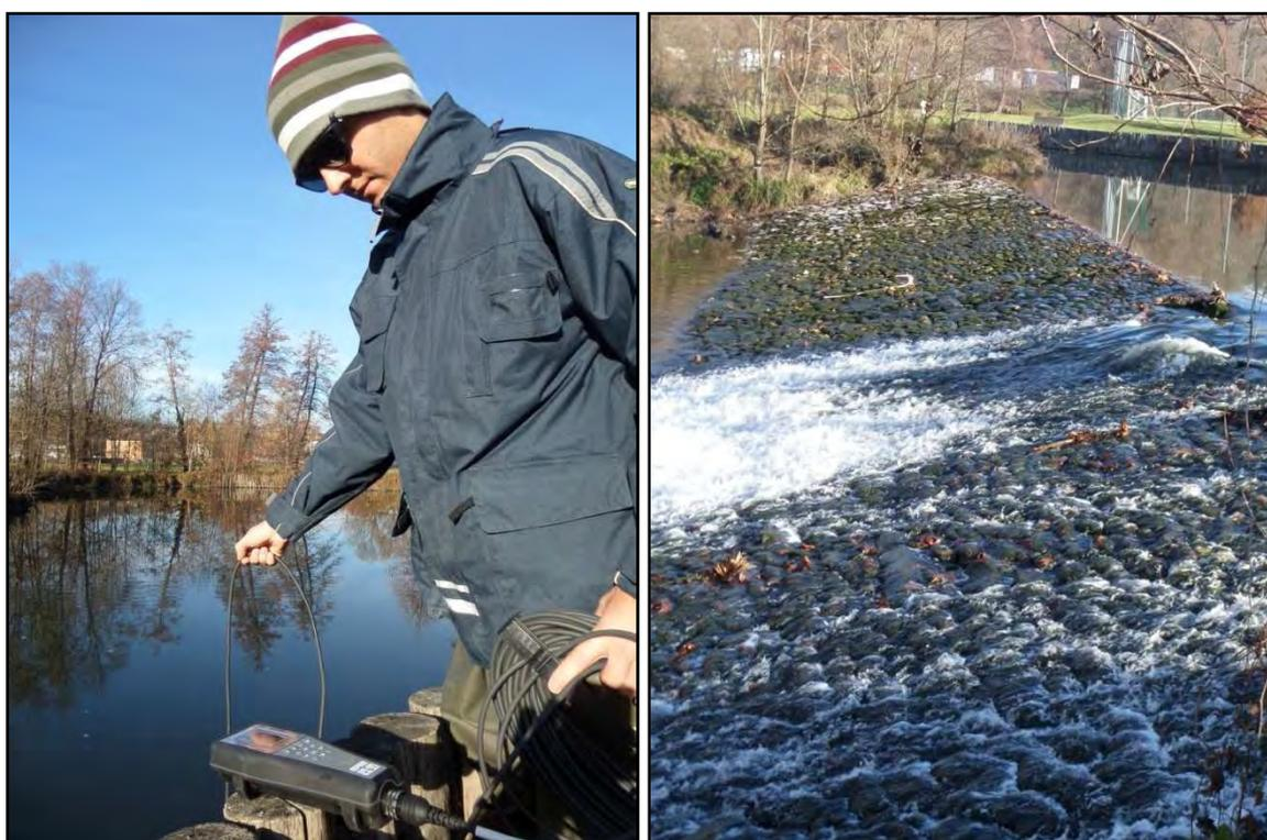
**Fig. 4.14:** a) Monitoraggio parametri chimico-fisici mediante sonda multiparametrica da campo – Area 3
