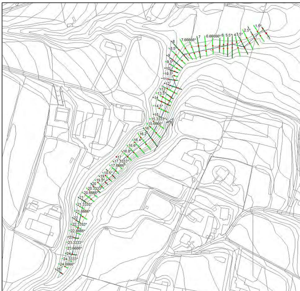
Figura 10 – Geometria di modellazione per lo stato di fatto della roggia a Sud
