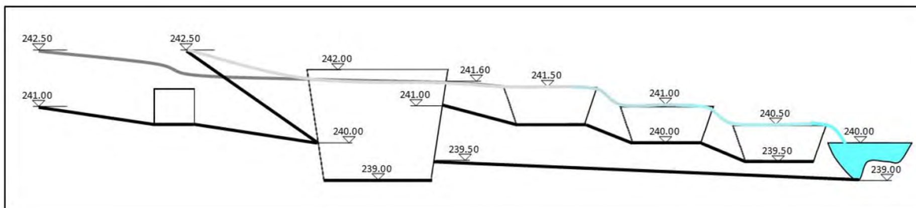
Figura 14 – Schema idraulico del sistema di finissaggio
