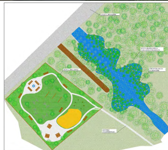
Figura 14 – Pianta tipo delle vasche di sedimentazione e delle aree ricreative
