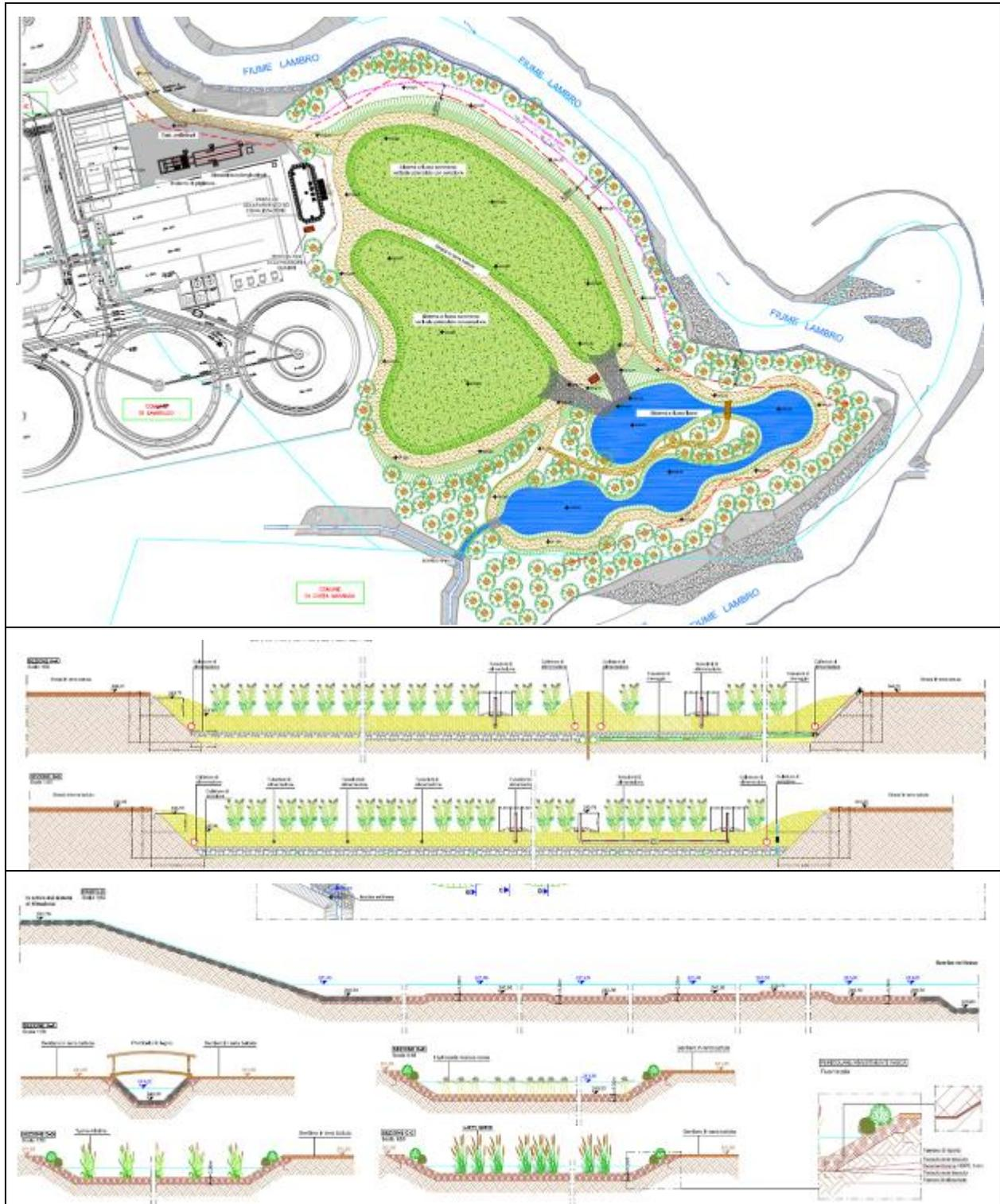
Figura 2: a) planimetria generale dell'intervento, b) sezioni della parte a flusso sommerso e c) sezioni della parte a flusso libero dell'impianto di Merone
